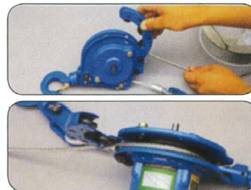
7. Paina vaijeria puristintelamekanismilla. (Nosta puristintelaa noin 90 astetta ja pujota vaijeri ulostulotelan ja puristintelakotelon väliin. Vedä vaijeria pääty pysäyttimen suuntaan niin, että se sopii köysipyörän uran pohjaan. Sulje puristintelamekanismi runkoon puristaaksesi vaijeria.)
