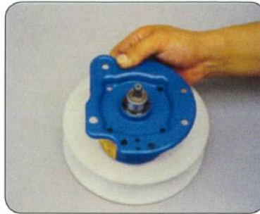
14. Irrota voimantuottopuolen runkokehys vastaavalta akselilta.
