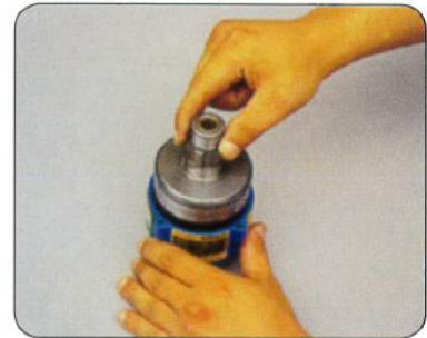
15. Irrota voimantuottoakseli sisäisestä vaihteistokotelosta.
