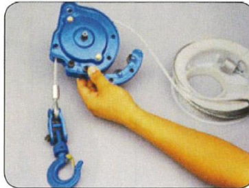
4. Syötä vaijeri vinssin köysipyörälle (suunta: läpiviennin lukitustapilta puristintelalle).
