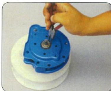
7. Irrota lukkorengas syöttöpuolen runkokehyksestä.
