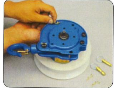
3. Poista läpiviennin ja puristintelakotelon lukitustapit ja sokat.
